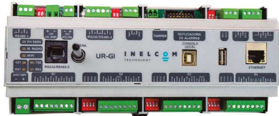
UNIDAD CENTRAL DE COMUNICACIONES
