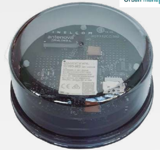
Unidades de telecontrol de luminarias con formato ZHAGA .
