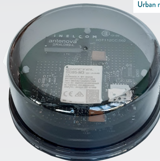
Unidades de telecontrol de luminarias con formato ZHAGA.
