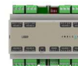
UA-8R: Módulo de 8 salidas de relé.
